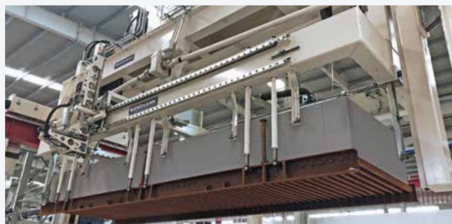
Компания JING NENG POWER ввела в эксплуатацию линию производительностью 600.000 м 3 /год под Пекином. Погрузчик оборудован прекрасным зарекомендовавшим себя автоматом-установщиком ракетов для штабелирования решеток с массивами на автоклавных вагонетках.
