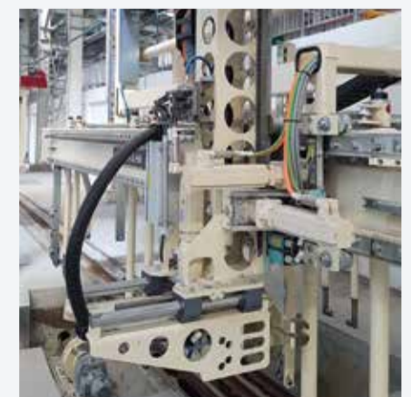
Компания JING NENG POWER ввела в эксплуатацию линию производительностью 600.000 м 3 /год под Пекином. Погрузчик оборудован прекрасным зарекомендовавшим себя автоматом-установщиком ракетов для штабелирования решеток с массивами на автоклавных вагонетках.
