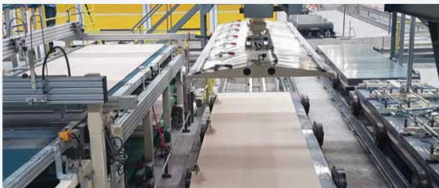
ESSE, Китай: В июле 2019 г. введена в эксплуатацию вторая линия: производительность 10 т/ч, длина листа 4880 мм. Система штабелирования оснащена двумя вакуумными колпаками для укладки фиброцементных листов и стальных прокладочных листов.
