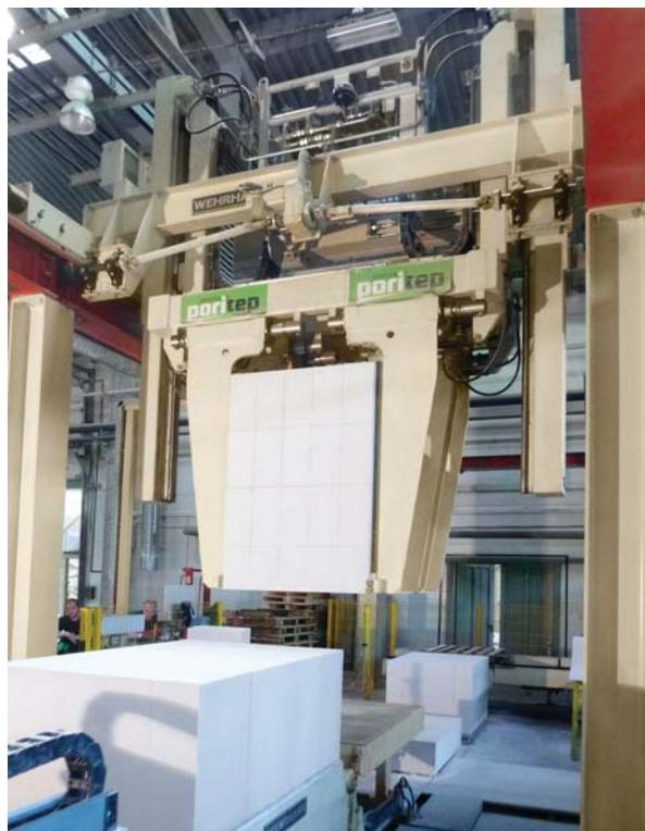
Рис. 4. Перестановщик блоков Wehrhahn: линия упаковки может быть дооснащена
