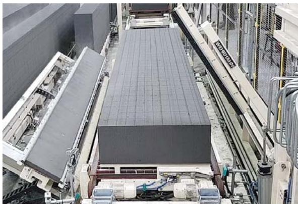
Рис. 1. Установка удаления нижнего подрезного слоя Wehrhahn
