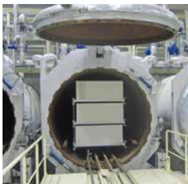
SMART: le cake en position horizontale pendant l'autoclavage.
