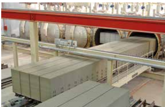
PLUS: le cake en position verticale pendant l'autoclavage.
