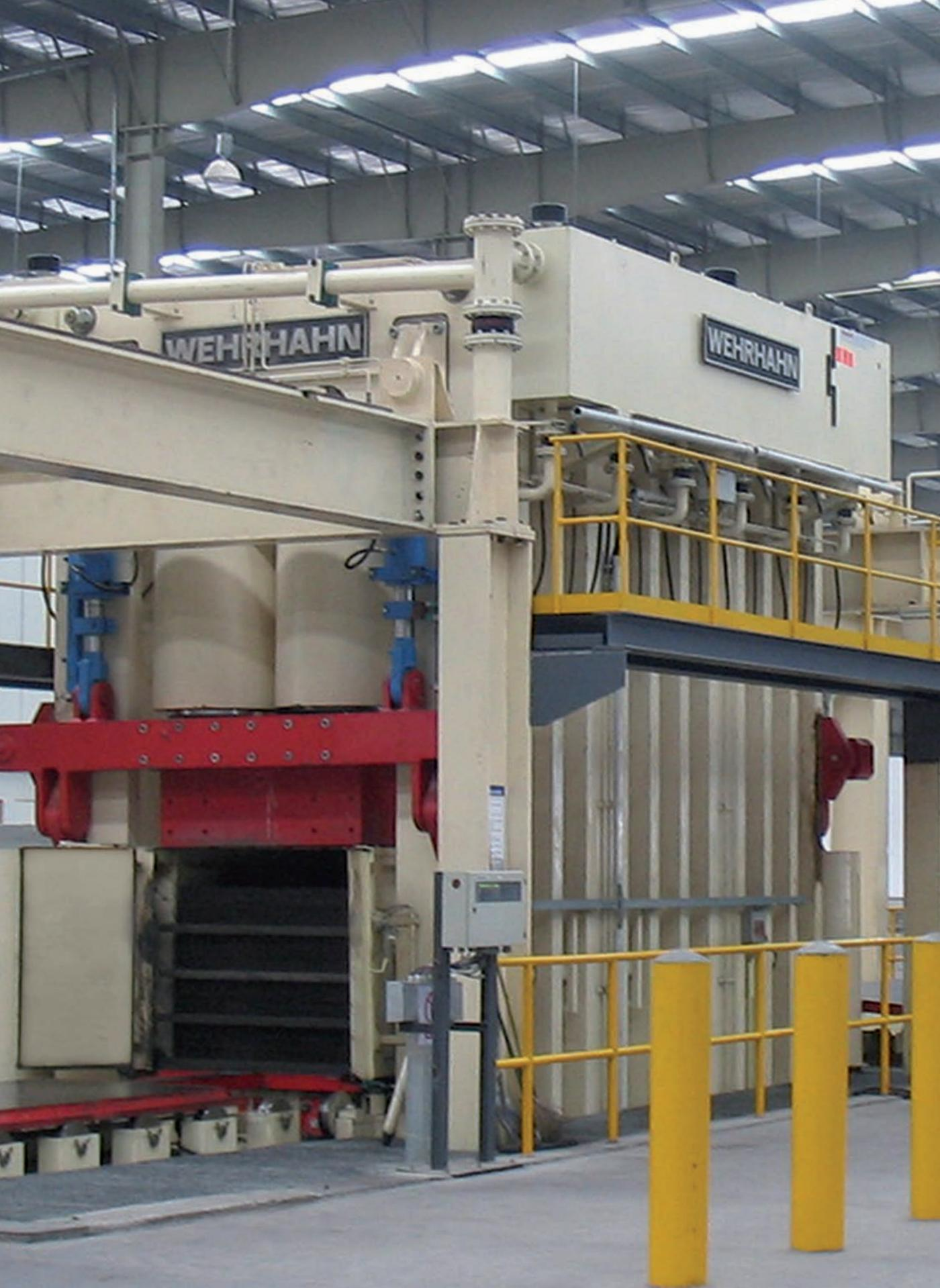
用于生产加压板材的堆压机或单板压机。
