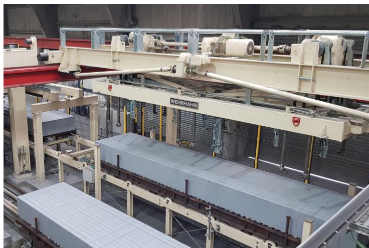
Рис. 1. Электромеханический привод подъёмного механизма погрузчика
