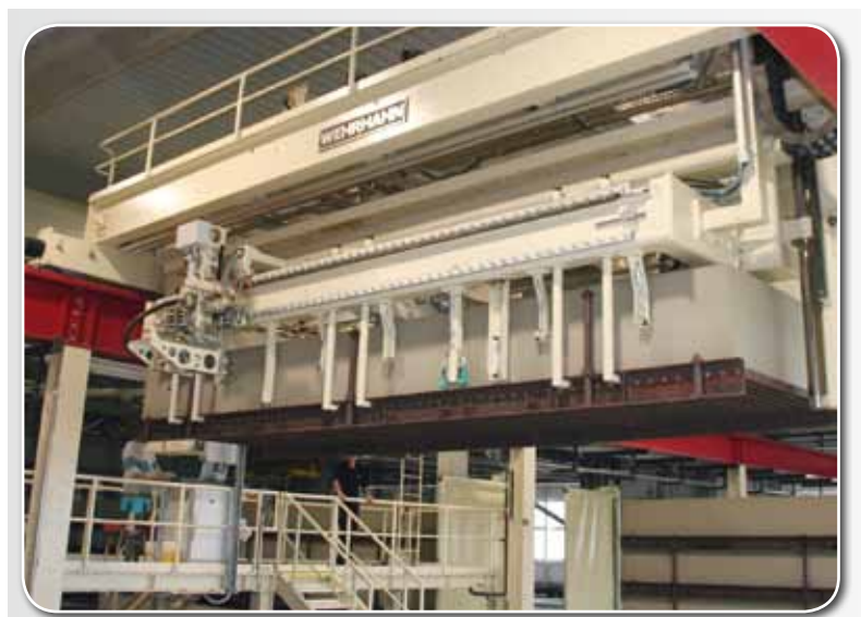
Lader mit automatischem Stapelstützeneinleger (superSMART)
